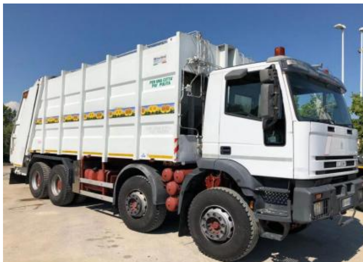
ЗУРАГ 37. 4 ТЭНХЛЭГТЭЙ НЯГТРУУЛАГЧ МАШИН.
