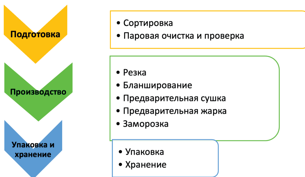
Рисунок 8. Производственный процесс переработки картофеля
