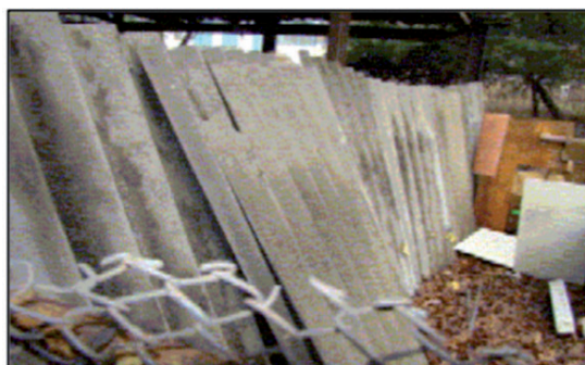
В. Дээврийн асбестон хавтангуудыг хадгалж буй байдал
